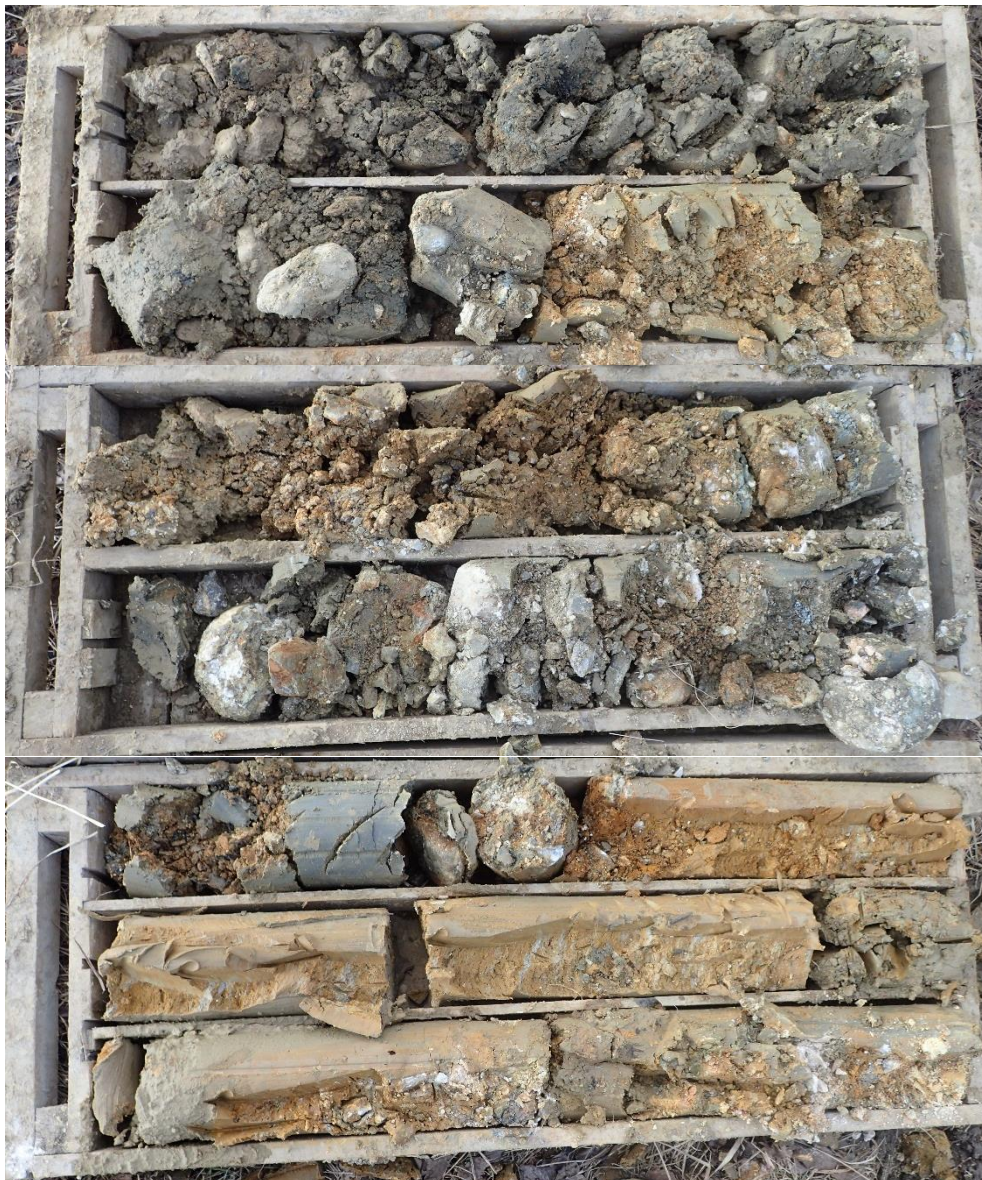
Foto 7: Profil inženýrsko-geologického vrtu J19
